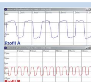
Gitterhöhe etwa 8 \mu m, Gitterbreite etwa 220 \mu m
