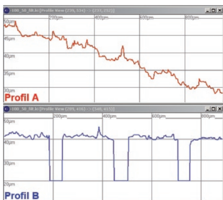
Abb. 2: Schnitt A: Höhenprofil entlang Goldkontakt, Schnitt B: Höhenprofil senkrecht dazu, Schichthöhe ca. 21 \mu\text{m} .
