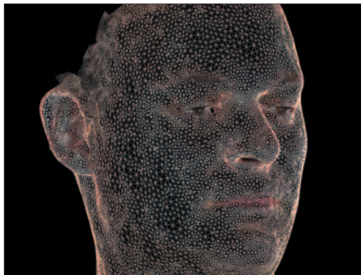
Optische 3D-Vermessung mit Farbtexur. (Die Darstellung als Dreiecksnetz wurde gewählt, weil sich sonst das Bild von einem Foto nicht unterscheidet) (Quelle: 3D-SHAPE)
